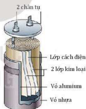
Hình 21.5. Cấu tạo của tụ điện hình trụ
