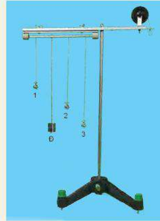
Hình 6.3. Thí nghiệm về dao động cưỡng bức
