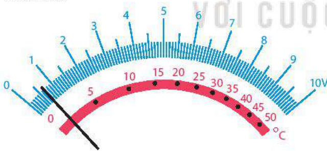
Hình 8.9. Thang chia độ tuyến tính và phi tuyến: thang màu xanh ứng với trường hợp tuyến tính; thang màu đỏ ứng với trường hợp phi tuyến
