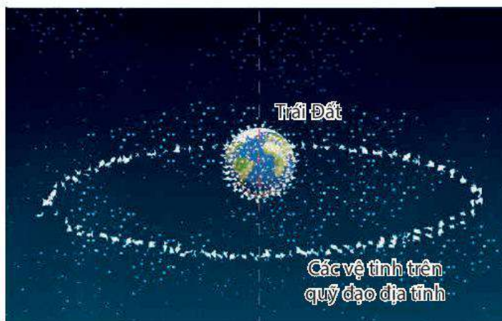
Hình 3.6. Hình mô phỏng sự phân bố vệ tinh theo các quỹ đạo Trái Đất. Vòng tròn to ngoài cùng là các vệ tinh trên quỹ đạo địa tĩnh.
