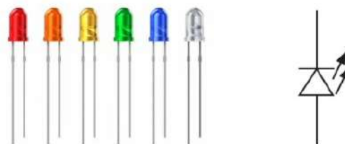
Hình 2.2. Các LED có màu khác nhau và kí hiệu của LED trong sơ đồ.
