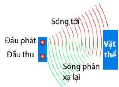
Hình 1.3. Đo khoảng cách bằng siêu âm
