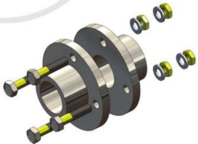
Hình 4.2. Các chi tiết của đầu nối ống
