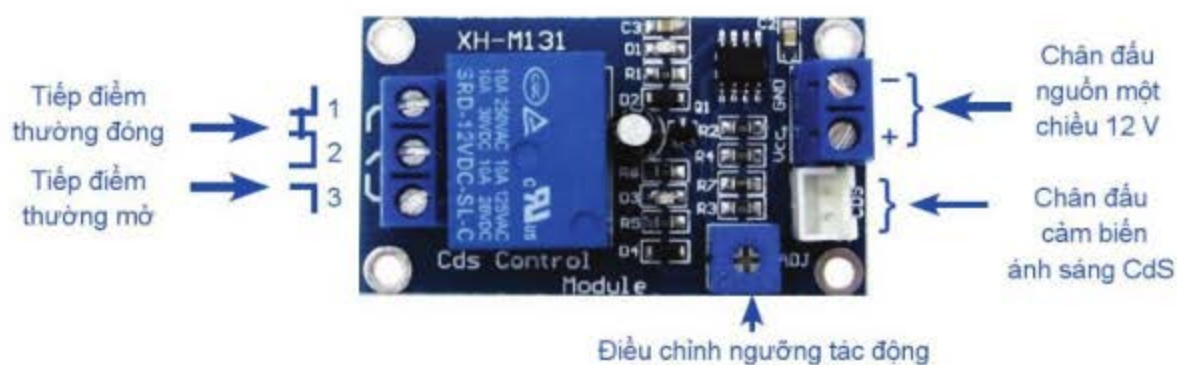
Hình 14.2. Chân đầu nối của mô đun cảm biến ánh sáng CdS
