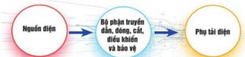
Hình 12.2. Sơ đồ khối cấu trúc chung của mạch điện
