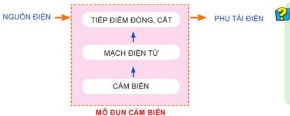
Hình 13.4. Sơ đồ khối mạch điều khiển sử dụng mô đun cảm biến
