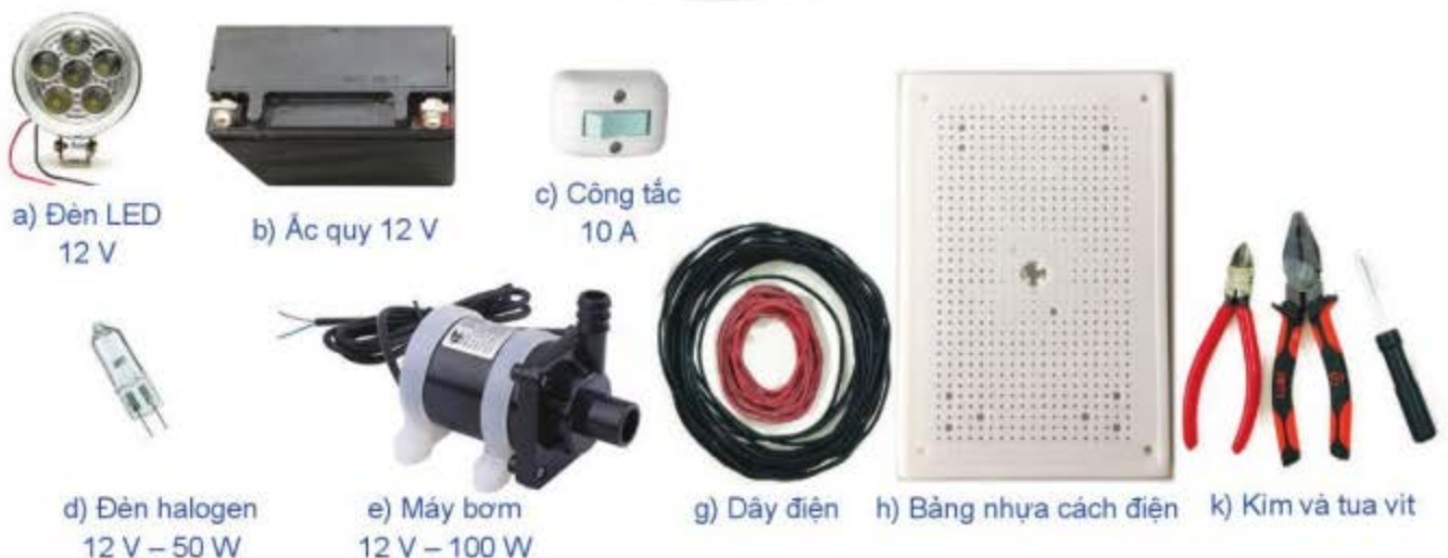
Hình 14.8. Một số thiết bị và dụng cụ lắp ráp mạch điều khiển
