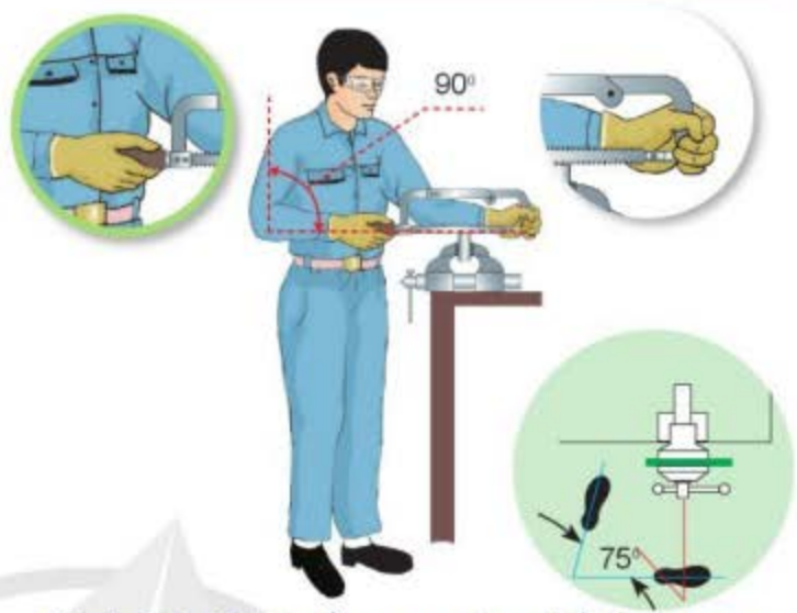
Hình 7.3. Cách cầm cưa và tư thế đứng cưa
