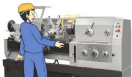
Hình 14.3. Áo của công nhân bị quấn vào máy
