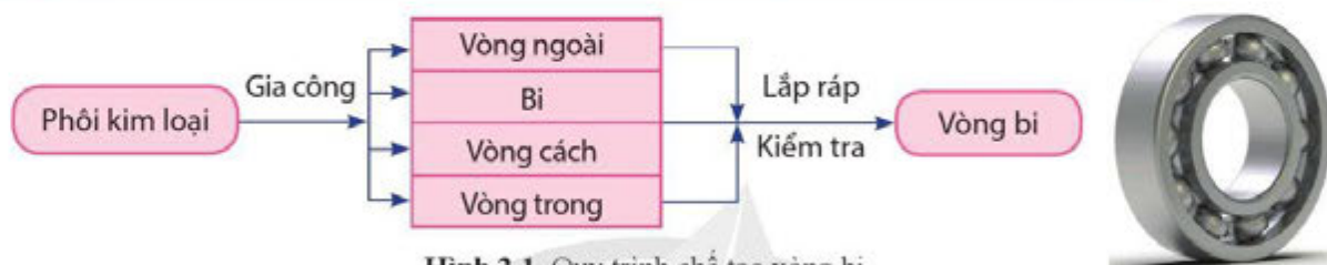
Hình 2.1. Quy trình chế tạo vòng bi
