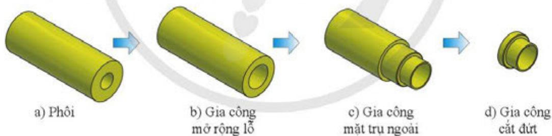
Hình 2.5. Trình tự gia công chi tiết bạc lót
