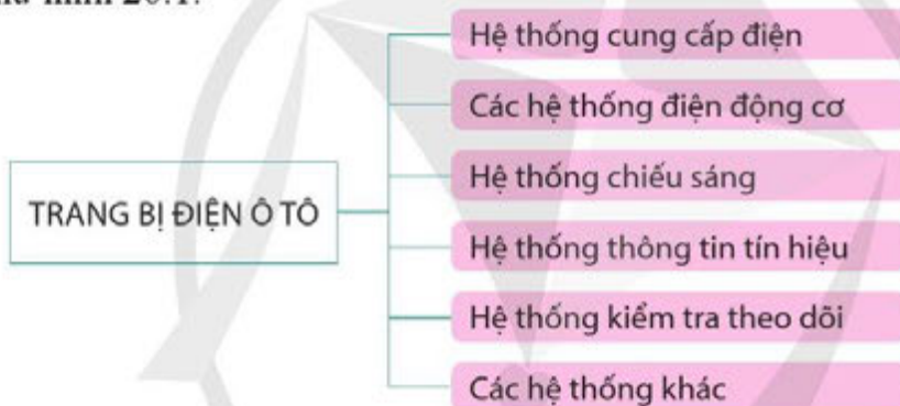
Hình 26.1. Sơ đồ trang bị điện trên ô tô
