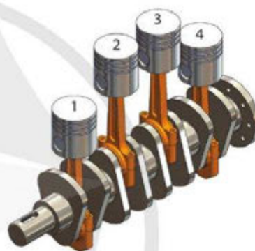
Hình 18.8. Bộ trí cơ cấu trục khuỷu thanh truyền động cơ 4 xilanh
