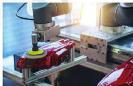
Hình 12.9. Robot đánh bóng bề mặt
