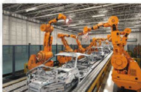
Hình 12.13. Robot lắp thân vỏ vào khung gầm ô tô
