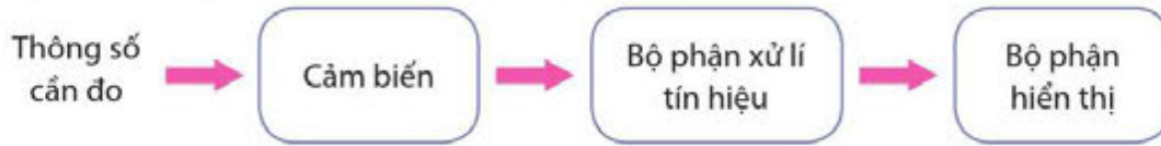
Hình 26.5. Sơ đồ cấu trúc hệ thống kiểm tra theo dõi trên ô tô
