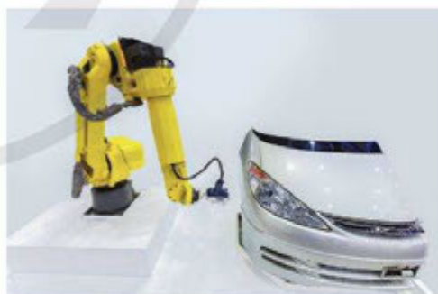
Hình 12.14. Robot kiểm tra hình dạng và kích thước một số bộ phận của ô tô
