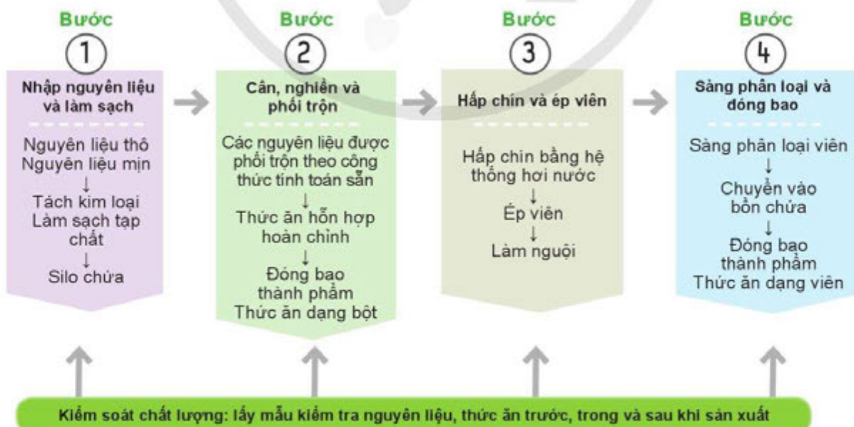
Hình 10.4. Quy trình sản xuất thức ăn hỗn hợp hoàn chỉnh ở quy mô công nghiệp
