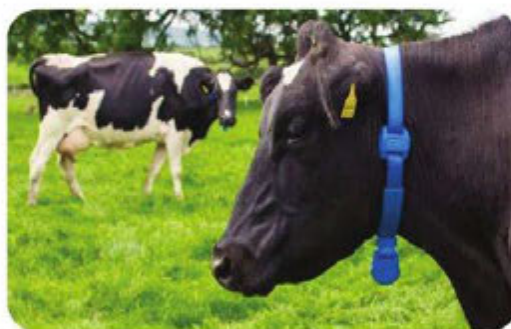
b. Thiết bị cảm biến đeo cổ để phát hiện sớm bệnh cho bò
