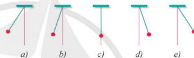
Hình 10. Các khung hình của chu kỳ dao động của con lắc
