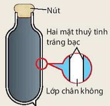
Hình 28.6 Cấu tạo ruột phích (bình thủy)
