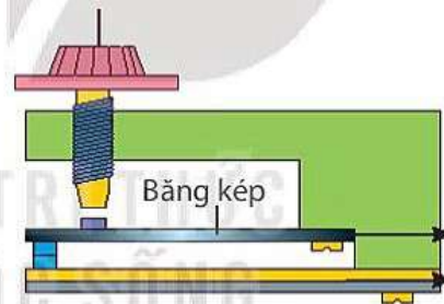
b) Băng kép đóng ngắt mạch điện
