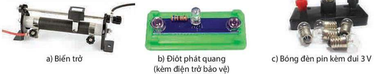
Hình 1.8 Một số thiết bị sử dụng điện
