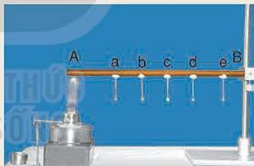
Hình 28.1 Bố trí thí nghiệm tìm hiểu sự dẫn nhiệt
