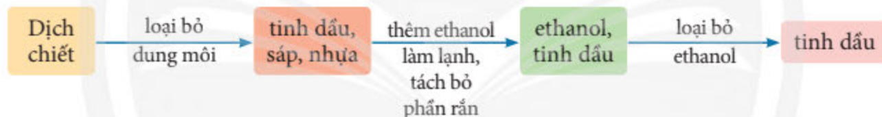
▲ Sơ đồ 4.2. Quy trình tách tinh dầu tỏi từ dịch chiết hexane
