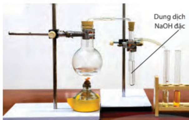
▲ Hình 13.5. Điều chế và thử tính chất của ethylene
