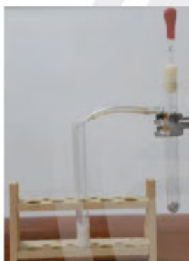
▲ Hình 13.7. Acetylene tạo kết tủa vàng nhạt với dung dịch AgNO_3 trong ammonia
