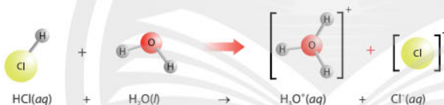
▲ Hình 2.4. Sơ đồ minh hoạ quá trình tương tác của HCl và nước trong dung dịch
