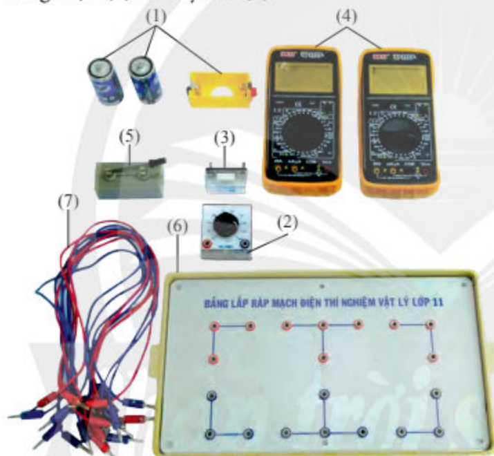
▲ Hình 20.3. Bộ dụng cụ đo suất điện động và điện trở trong của nguồn điện
