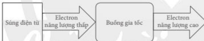
▲ Hình 13.6. Sơ đồ nguyên lí của máy gia tốc tuyến tính dùng electron
