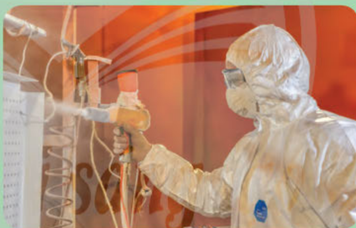
▲ Hình 11.4. Công nhân đang sơn vật bằng công nghệ sơn tĩnh điện
