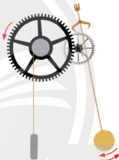
▲ Hình 4.5. Cơ chế bổ sung năng lượng cho đồng hồ quả lắc
