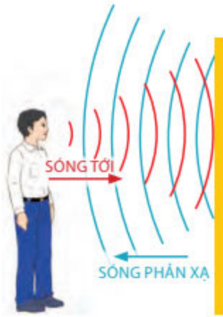
▲ Hình 5.7. Sóng âm phản xạ khi gặp bức tường nên tai người nghe được âm thanh vọng lại
