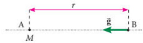
Hình 3.1. Vectơ cường độ trường hấp dẫn tại B do chất điểm khối lượng M sinh ra
