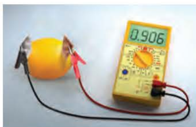
▲ Hình 12.6. Sơ đồ pin chanh
