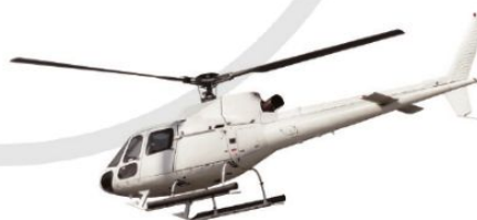
Hình 18.3. Khung và cánh của máy bay trực thăng được chế tạo từ hợp kim của magnesium
