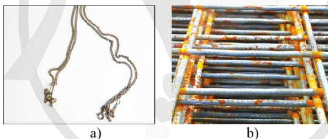
Hình 16.3. Đồ trang sức bằng bạc bị ăn mòn (a) và khung thép bị ăn mòn (b)
