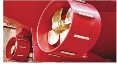
Hình 16.7. Các khối kẽm được hàn vào một bộ phận của tàu làm bằng thép để chống ăn mòn
