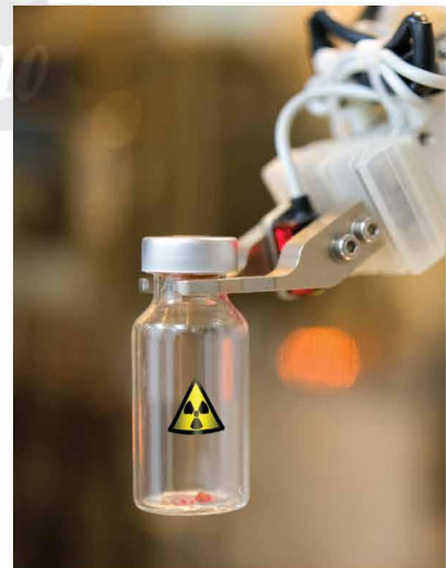
▲ Hình 18.5. Sử dụng tay robot để làm việc với nguồn phóng xạ
