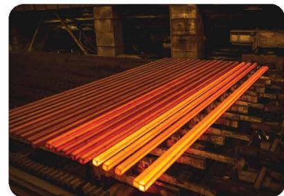
▲ Hình 3.5. Các thanh thép được đưa ra khỏi khuôn và để nguội trong nhà máy luyện thép
