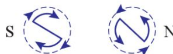
Hình 1.13. Quy ước mặt nam (S) và mặt bắc (N) của dòng điện tròn
