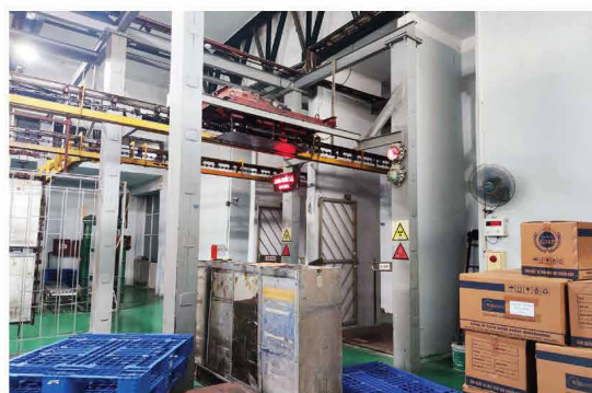
Hình 25.3. Khu nạp nguyên liệu vào dây chuyền chiếu xạ – Trung tâm chiếu xạ Hà Nội
