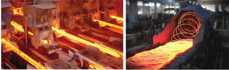
Hình 3.5. Vật liệu kim loại tái chế được đổ khuôn hoặc kéo sợi
