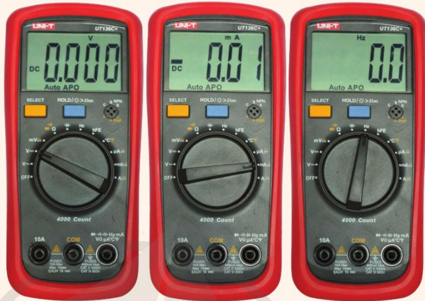
Hình 1.8. Ba thang đo điện áp, cường độ dòng điện và tần số bằng đồng hồ đo điện đa năng
