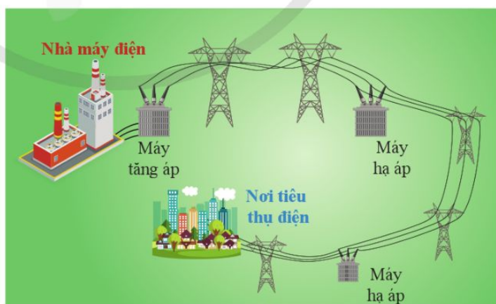
Hình 2.4. Sơ đồ minh họa hệ thống truyền tải năng lượng điện từ nhà máy phát điện đến nơi tiêu thụ
