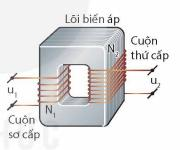
Hình 3.1. Sơ đồ cấu tạo chính của máy biến áp
