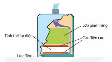
Hình 7.2. Cấu tạo của đầu dò siêu âm
