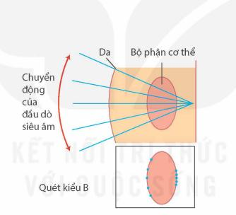
Hình 7.6. Bằng cách di chuyển đầu dò, một loạt các dấu chấm trên màn hình tạo ra hình dạng của bộ phận đang được kiểm tra
