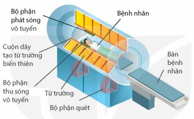
Hình 8.4. Cấu tạo sơ lược máy MRI
