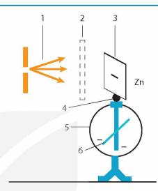
Hình 9.1. Thí nghiệm của Hertz năm 1887 phát hiện hiệu ứng quang điện
