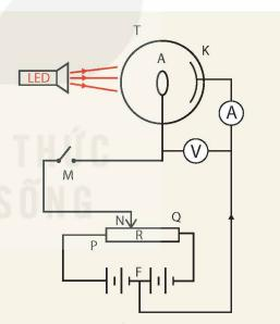
Hình 9.7. Sơ đồ mạch điện khảo sát cường độ dòng quang điện
