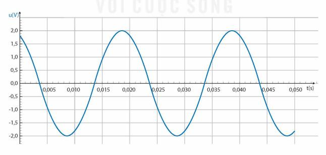
Hình 4.7a. Đồ thị điện áp chưa chỉnh lưu qua diode
