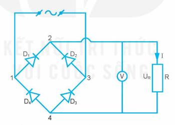
Hình 4.8. Cầu chỉnh lưu cả chu kì bằng 4 diode bán dẫn  $D_4$ ,  $D_9$ ,  $D_4$ ,  $D_4$
