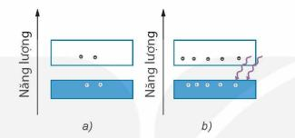
Hình 12.4. Sơ đồ vùng năng lượng của điện trở quang khi chưa được chiếu sáng (a) và được chiếu sáng (b)
