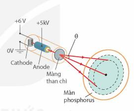
Hình 10.5. Mô hình ống nhiễu xạ electron
