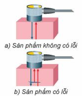
Hình 7.7. Ứng dụng siêu âm để kiểm tra khuyết tật của sản phẩm
